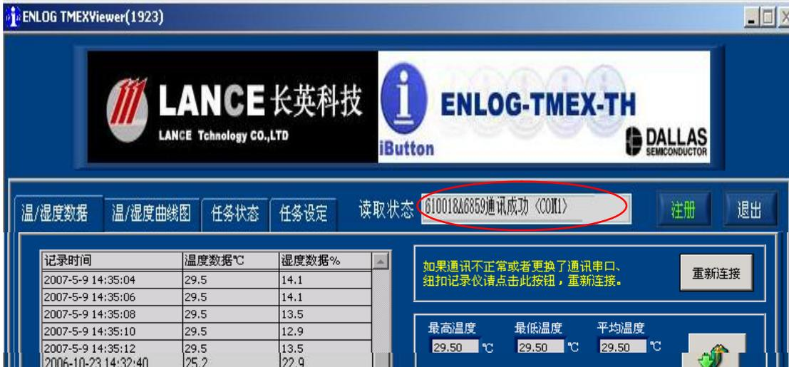
通讯成功后，“**读取状态**”窗口中将显示纽扣的序列号及读取正常的提示。
