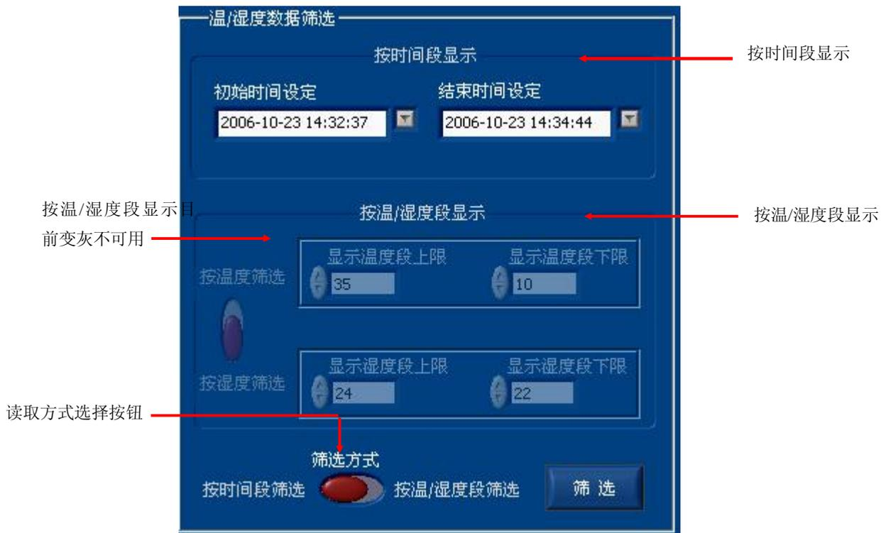
按时间段筛选包括初始时间设定和结束时间设定两个数据框，设定这两个时间时，使用数据框右面的下箭头按钮进行时间的选择；设定好时间后，单击“温度/湿度数据筛选”选项卡右下角的筛选按钮，系统就会按照设定的筛选规则进行重新筛选一次，并将结果显示在温度/湿度数据记录数据框内。
