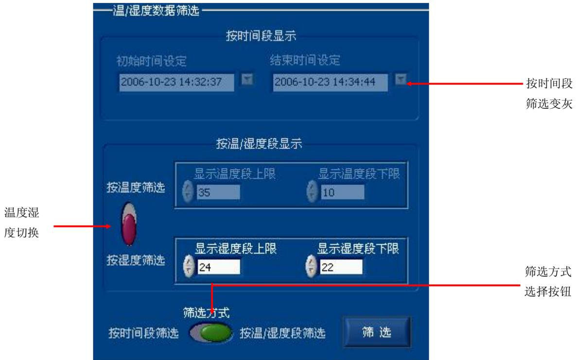
在设定温度/湿度上下限值后单击**筛选按钮**，系统会筛选上下限温度/湿度值内的温度/湿度数据，并显示在左面的温度/湿度数据框内。
