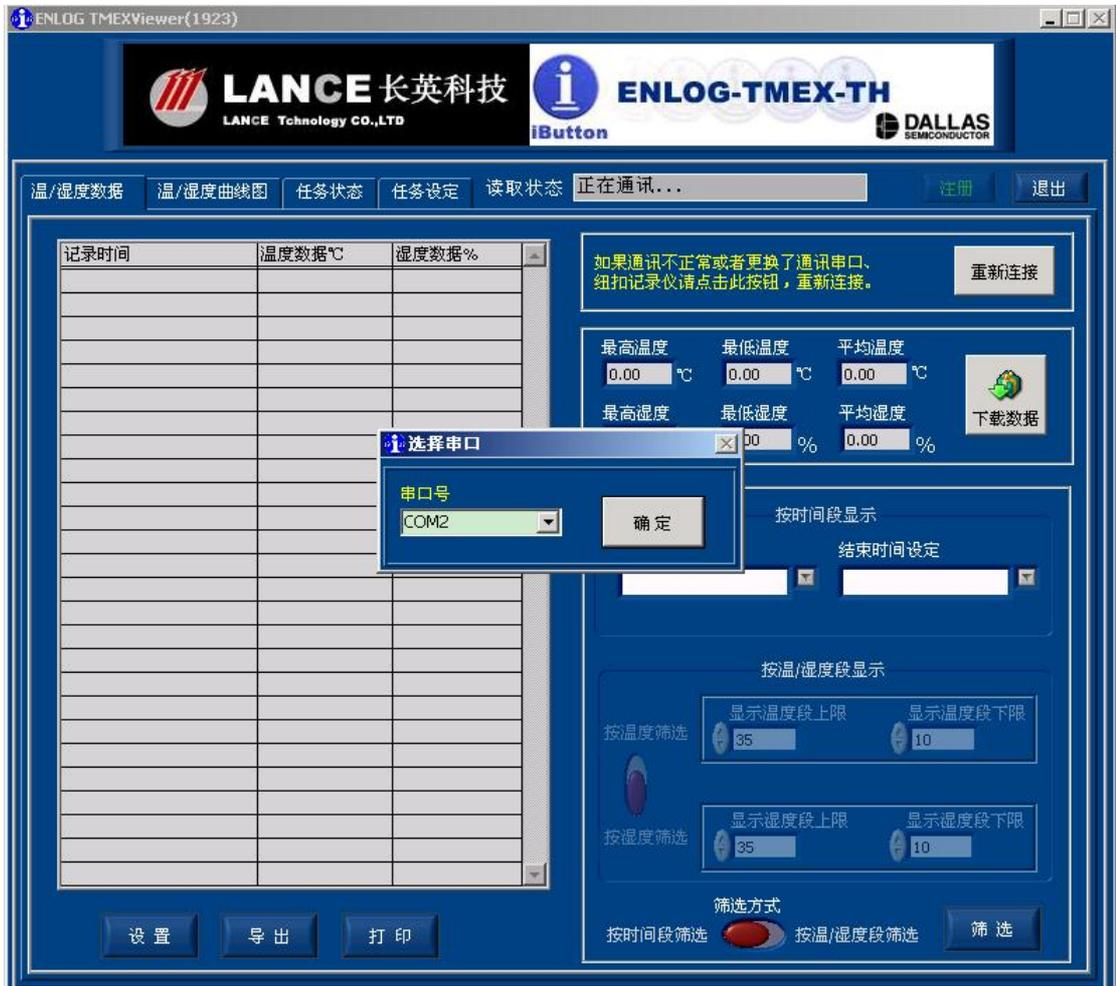
首先显示选择串口窗口，请根据所连接的串口选择合适的串口号，并点击确定。
