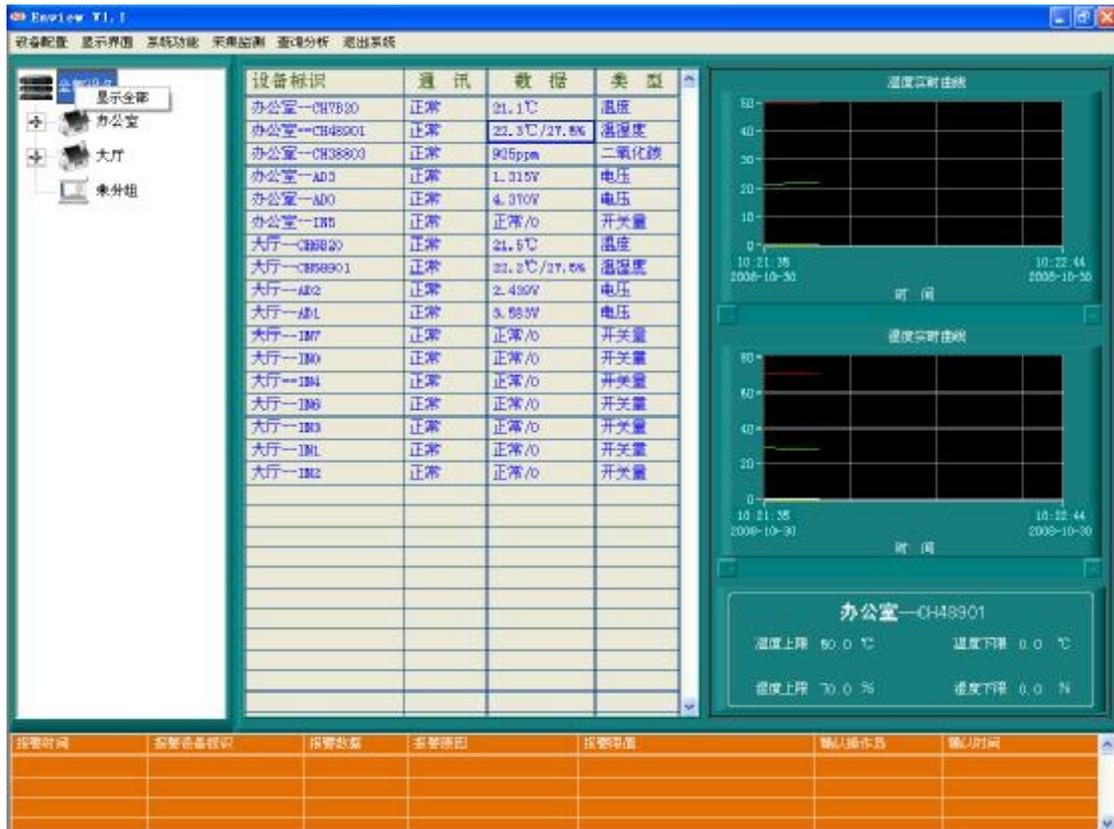
在设备列表中选择**组标识**，然后右键单击弹出菜单选择**显示本组**，软件将在数据列表中只显示该组内的传感器设备的数据，其它组的数据将被隐藏（如下图所示），该项操作能够使操作用户更加快速的浏览到想要查看的数据。避免了由于数据众多造成的浏览死角，同时避免了其它组的数据在浏览上的干扰。**注意：选择显示本组功能，只是在数据显示只显示该组的数据，其它组的数据仍然被实时采集刷新并进行处理分析。**
